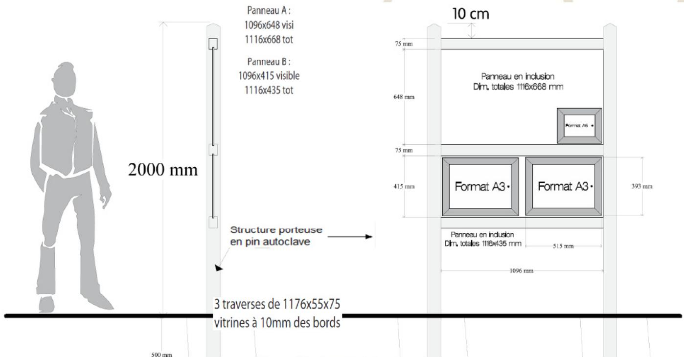
Figure 52 : format et structure du panneau
